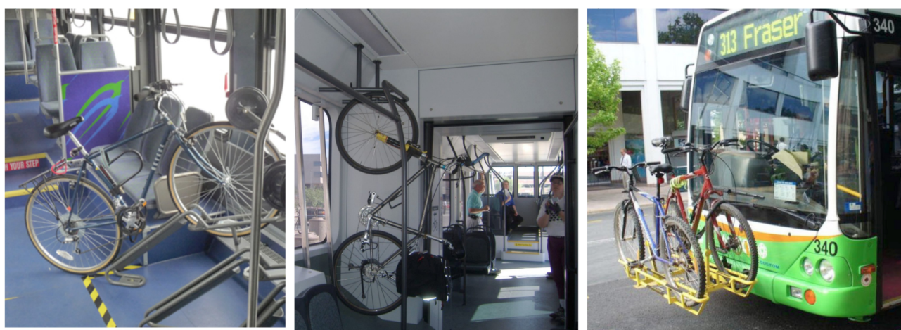
Rysunek 7a-7 Różne sposoby przewożenia rowerów środkami transportu zbiorowego: wewnątrz autobusu w uchwycie rowerowym, na wieszaku rowerowym, na bagażnikach rowerowych montowanych na autobusach
