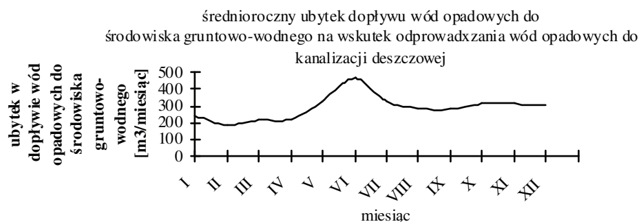
Wykres nr 5. Średnioroczny rozkład ubytku dopływu wód opadowych z terenu przedsięwzięcia do środowiska gruntowo-wodnego na skutek odprowadzania wód opadowych do zakładowej kanalizacji deszczowej Ø 200
