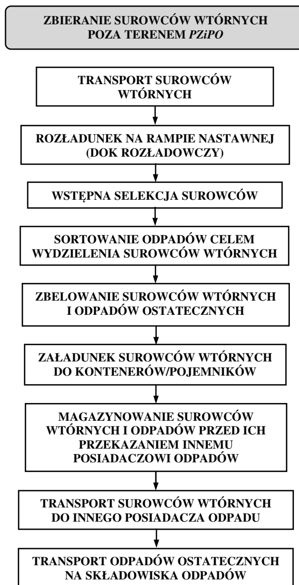
Schemat nr 3. Schemat jednostkowych procesów technologicznych w PZiPO
